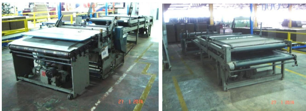
Poluautomatska kaširka – mazalica Grassi, Compact, 6.000€, 1993g., 1400 x 1400 mm, Zagreb, Hrvatska
